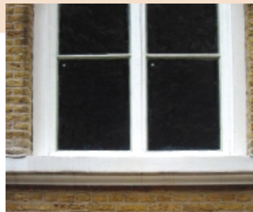
Proef van de Rijksgebouwendienst met vacuümglas in een monumentaal raam, waarbij onder meer het visuele effect en de bouwfysische gevolgen worden getest. Linksboven in het glas het ventiel (foto RGD)
